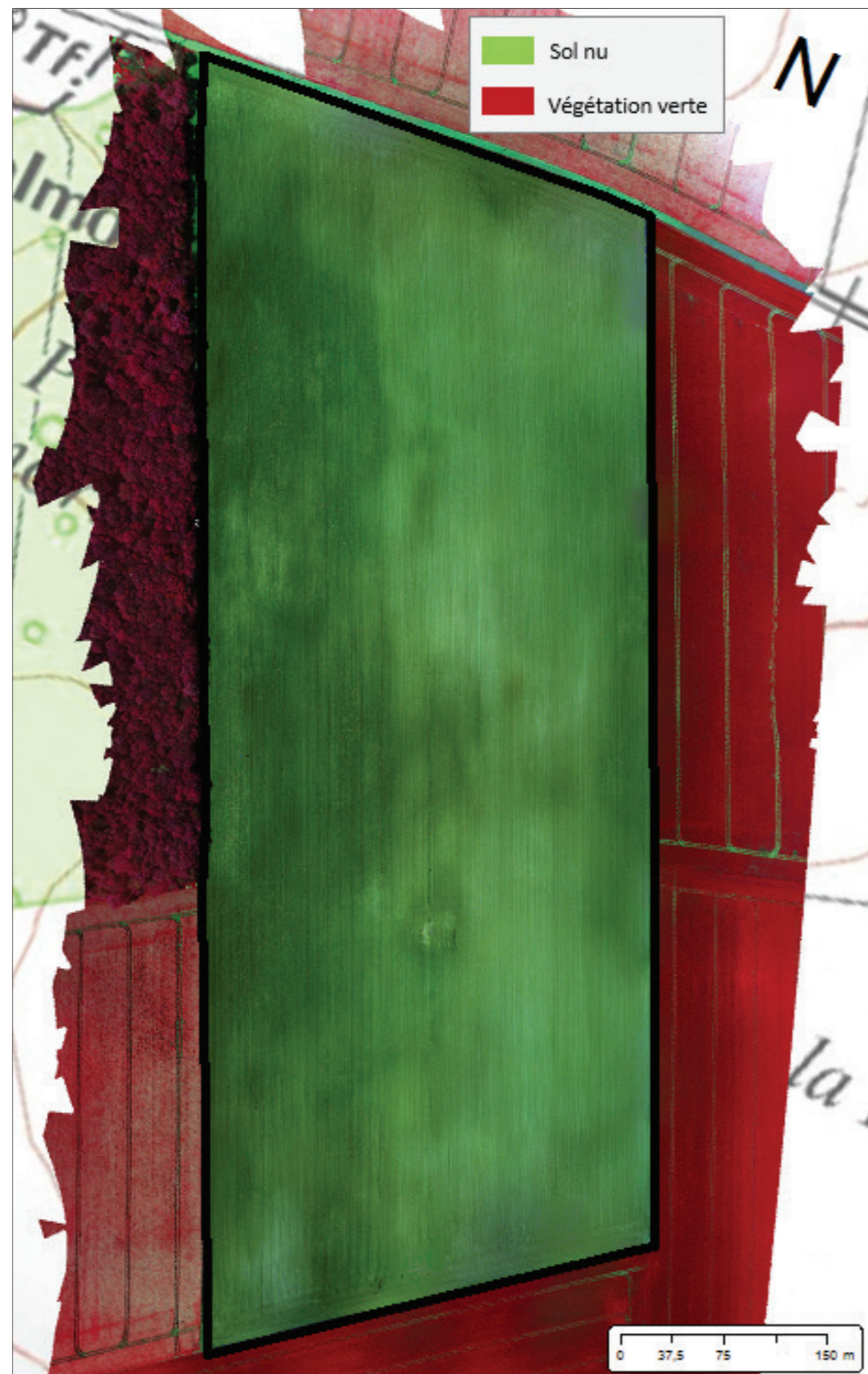
Mosaïque en fausses couleurs de 233 images drone d'une parcelle agricole de 28 ha, de la commune de Maule (78). Vol du 04/05/2016, drone eBee, caméra multiSPEC-4C AIRINOV visible proche-infrarouge. Résolution 13 cm, altitude de vol 125 m.
